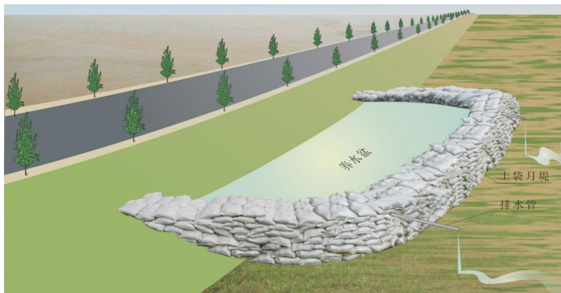
图 5-9 背水围堰（月坝）示意图一
